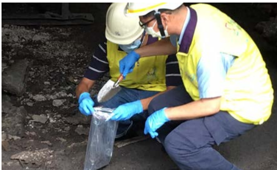
廠區周遭土壤取樣作業
